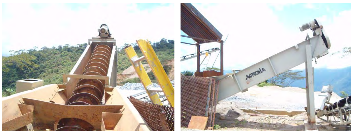
Figura 2-39 Tornillo lavador de arenas
