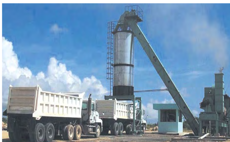
Figura 2- 29. Modelo de Planta de Asfalto
