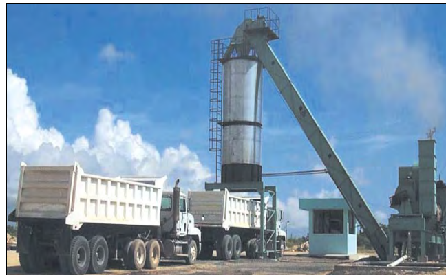
Figura 4 - 22. Modelo de Planta de Asfalto
