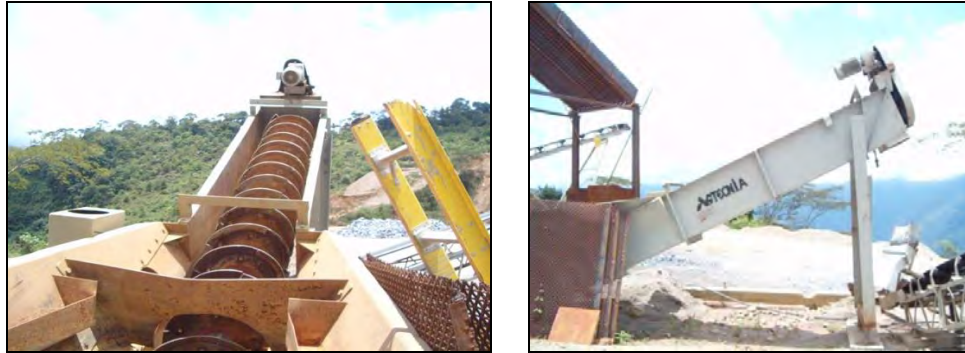
Figura 4 - 31. Tornillo lavador de arenas
