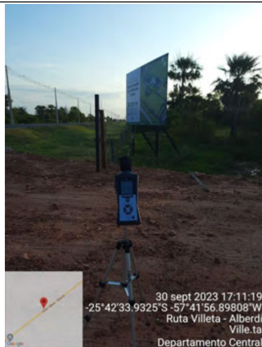
Fotografía 4. Monitoreo de Niveles Sonoros en el Punto 1 en horas de la tarde
