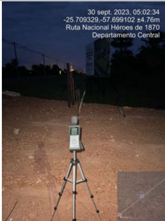
Fotografías 1. Monitoreo de Niveles Sonoros en horas de la mañana
