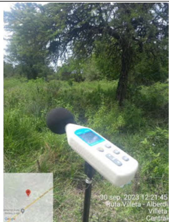
Fotografías 8. Monitoreo de Niveles Sonoros en horas de la mañana.
