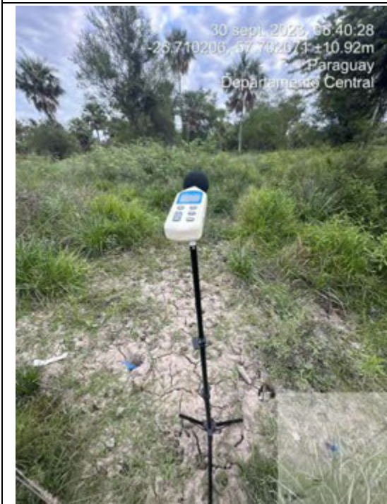
Fotografías 7. Monitoreo de Niveles Sonoros en horas de la mañana.
