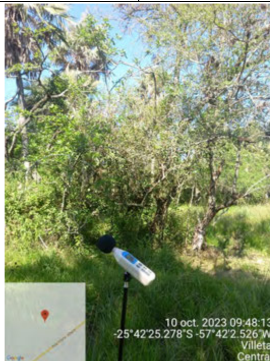
Fotografía 17. Monitoreo de Niveles Sonoros en horas de la mañana
