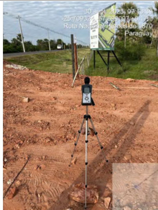
Fotografías 2. Monitoreo de Niveles Sonoros en horas de la mañana
