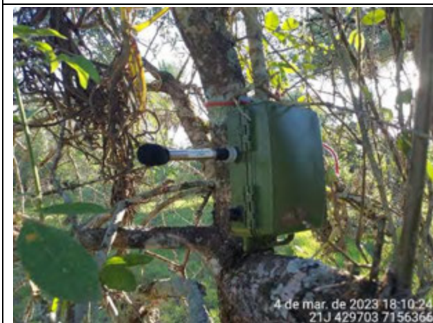
Foto 17: Detalle del dispositivo bioacústico Songmeter instalado para la detección de murciélagos (Primera Campaña).
