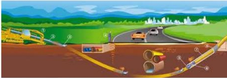
Figura 7.1 Ilustración del método constructivo para el cruce de cuerpos de agua
