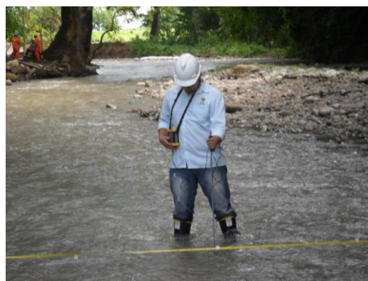
Figura 7-14 División transversal de la fuente y medición de profundidades
