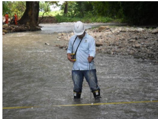
Figura 7-14 División transversal de la fuente y medición de profundidades
