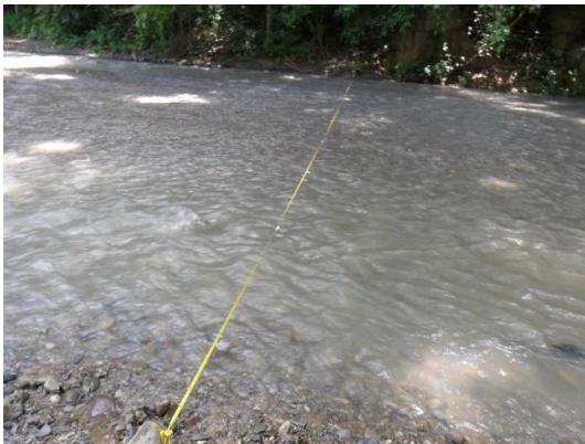
Figura 7-14 División transversal de la fuente y medición de profundidades
