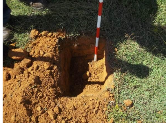
Pozo de sondeo
