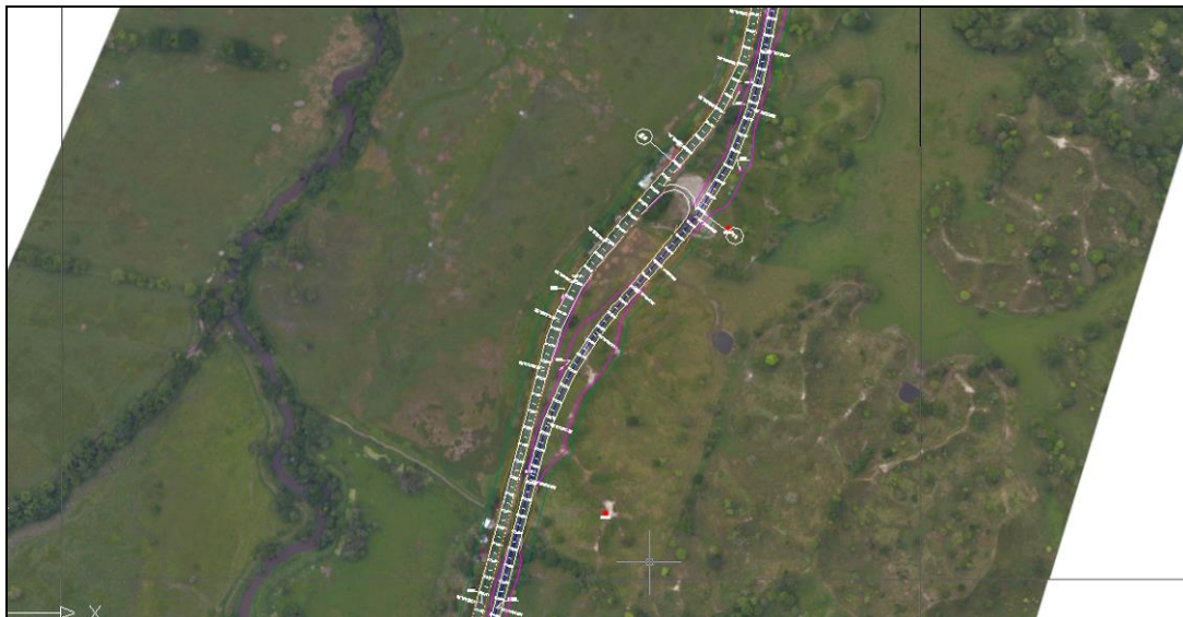
Figura 2-13 Sobreancho por retorno S-S al norte del centro poblado El Trique PR87+300 al PR88+000
