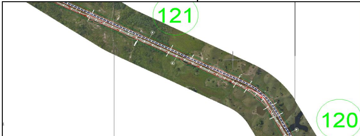
Figura 2-28 Sobreancho por diseño geométrico PR 119+970 al PR 120+860, ancho máximo de separador 16 m
