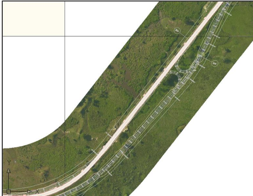
Figura 2-40 Sobreebanco por diseño geométrico y retorno doble incluye realineamiento de calzada. PR30+100 al PR31+100
