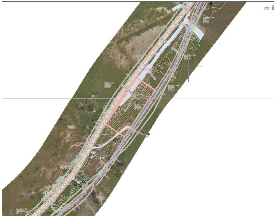
Figura 2-35 Sobreancho por retorno doble PR 7+350 al PR 8+900, donde se ubica el Área de Servicios de Zambito
