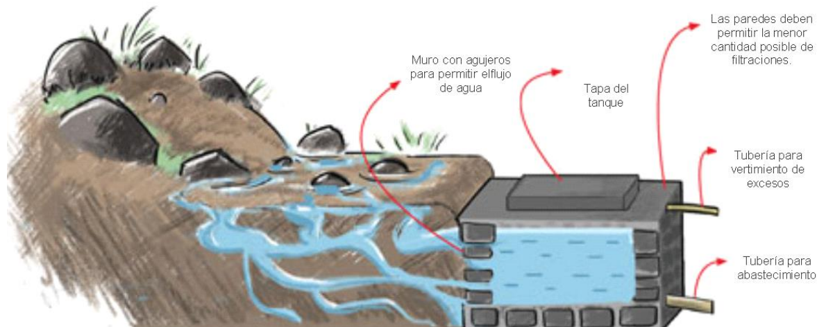
Figura 5-2.34 Tanque para la protección de afloramientos de agua
