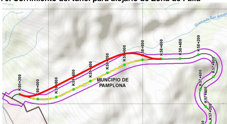
Figura 5-2.76. Corrimiento del túnel para alejarlo de Zona de Falla
