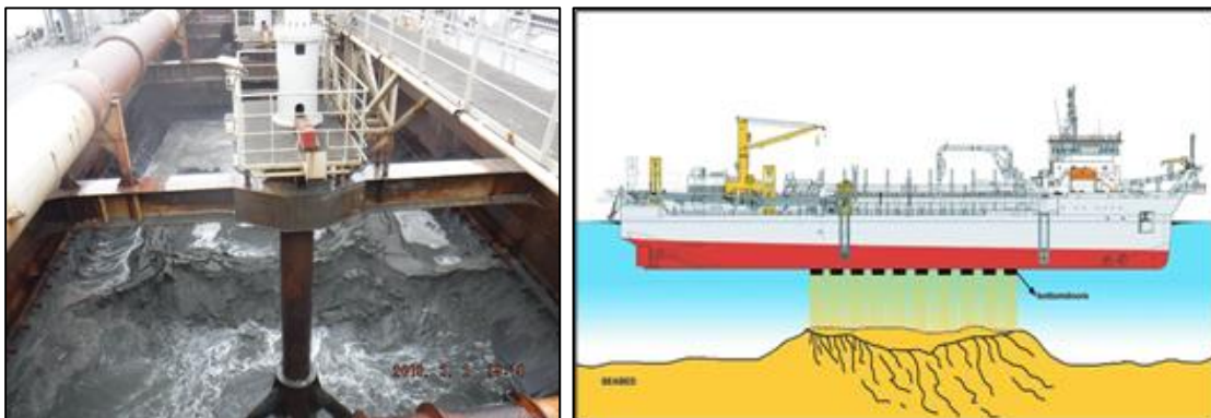
Figura 8. Cantara de TSHD llena y descarga a través de las compuertas Fuente: Documento dragado TPM, 2018.
