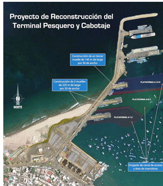
FIGURA No. 15. Instalaciones a construirse
