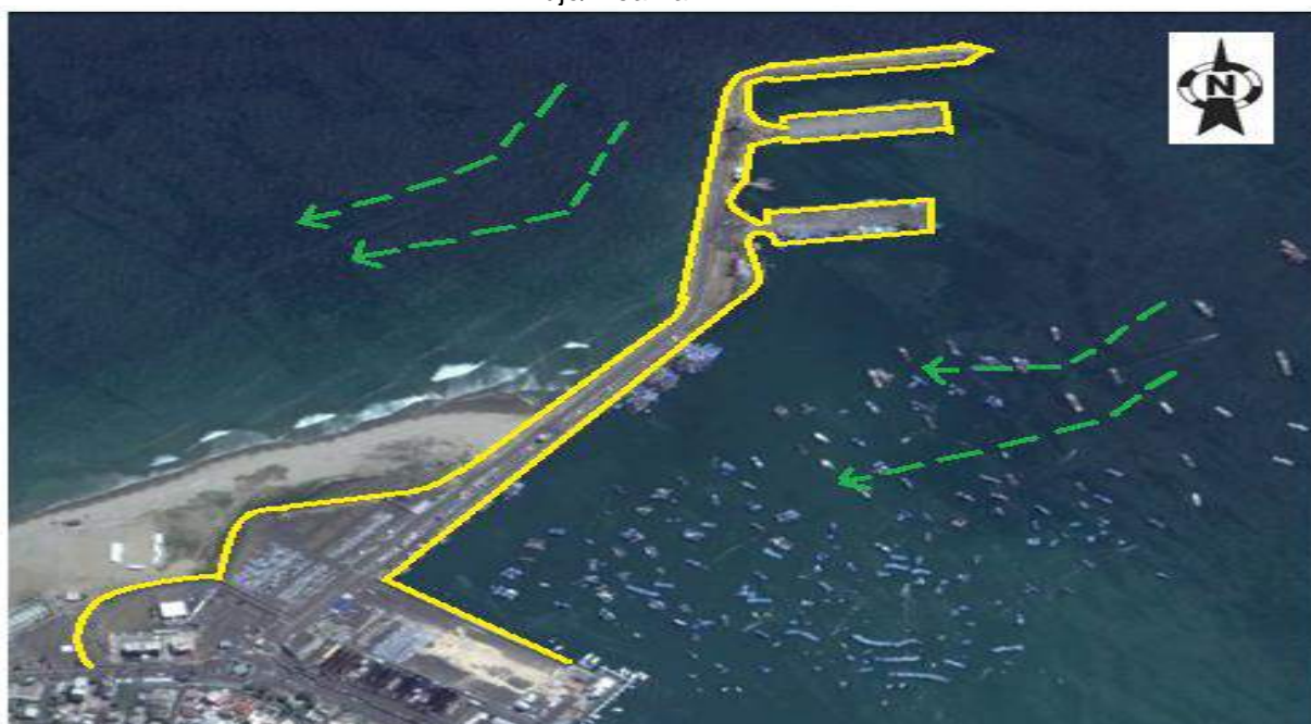
Figura 4-32. Circulación de corrientes Superficiales dentro del Puerto de Manta durante el Flujo/Pleamar.
