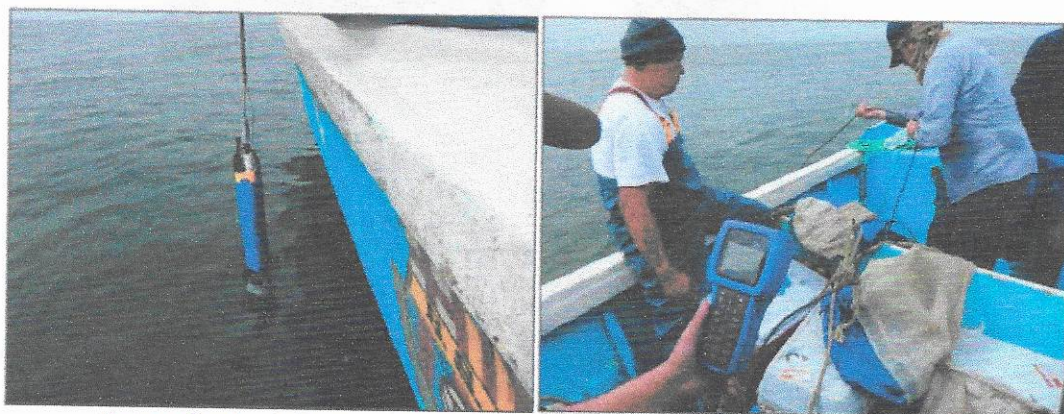
Fotografías 1 y 2: Registro de variables físico químicas con CTD EXO2 de la firma YSI
