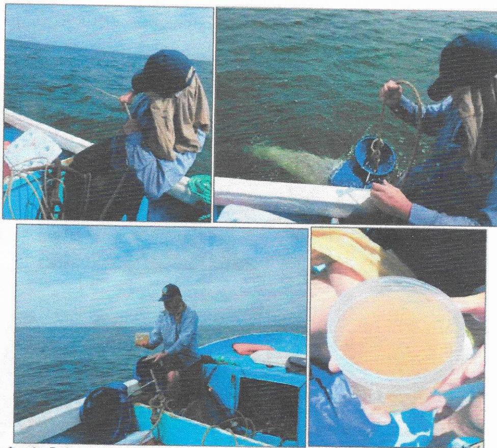
Fotografías 4 a 7: Arrastre con red tipo bongo. Concentración de muestras planctónicas con red tipo bongo
