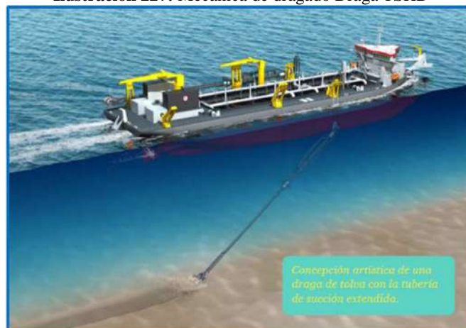
Ilustración 227: Mecánica de dragado Draga TSHD
