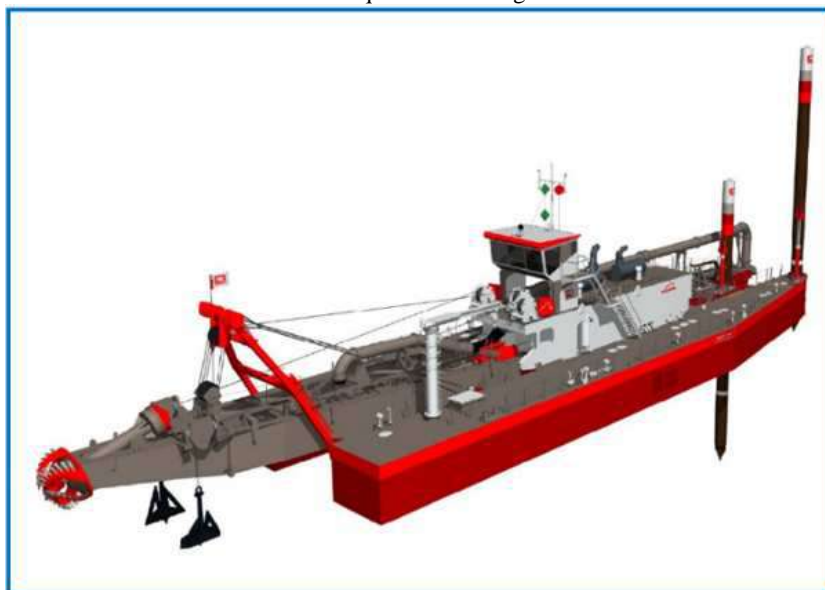
Ilustración 226: Esquema de la draga Beaver 6518C
