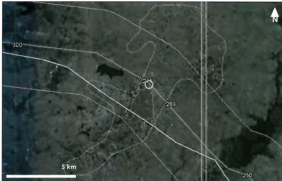
Figura 4-9: Zona de mayor concentración de manantiales (polígono turquesa) determinada mediante fotointerpretación, que queda aproximadamente comprendida la unidad hidrogeológica Las Arenas (Q1a). La línea fucsia indica el recorrido de la LAT; el círculo blanco indica la ubicación del manantial correspondiente a la fotografía de abajo, el cual quedará debajo la LAT entre dos torres.
