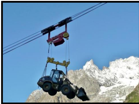
Ejemplo de teleférico cargando maquinaria pesada y tubería de acero
