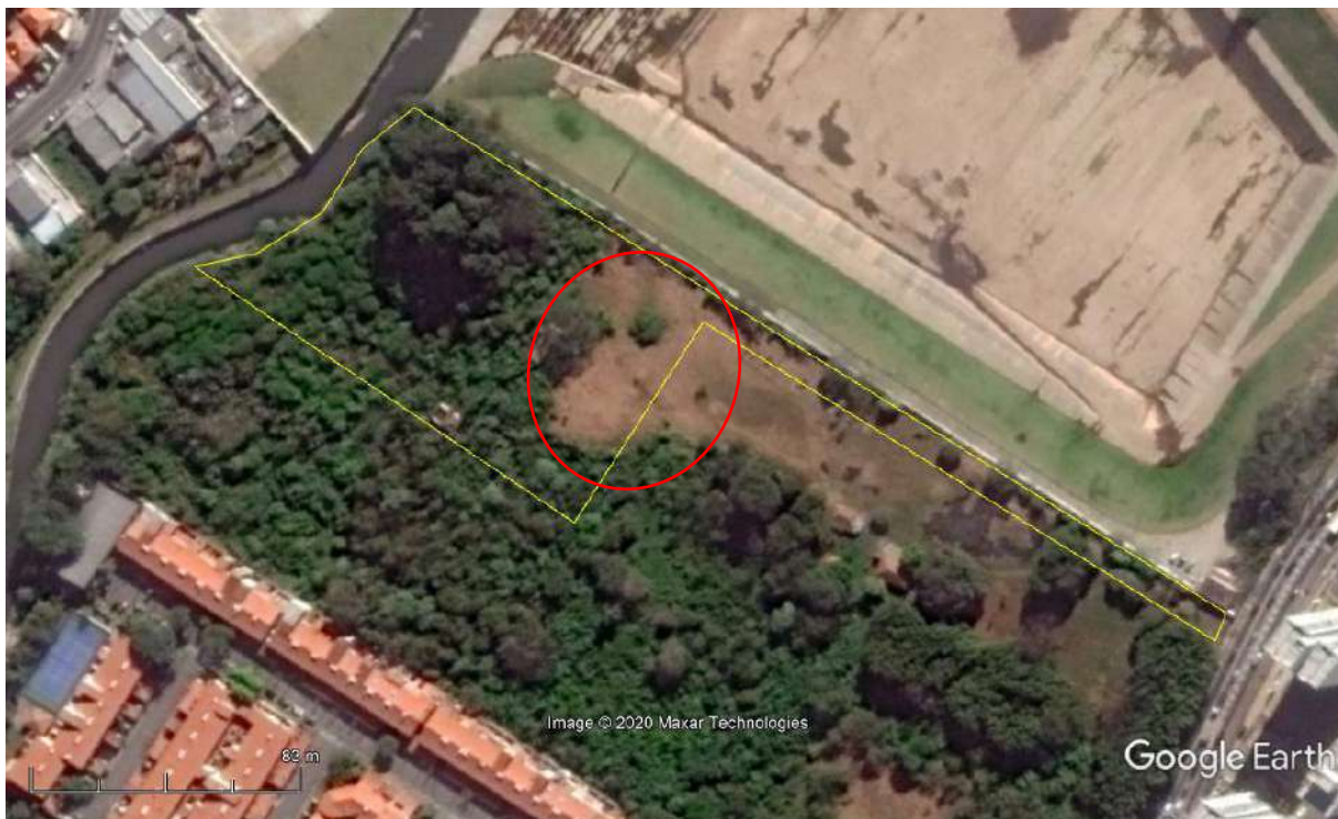
Imagem 4.1.3-6: Imagem Google Earth de 30/06/2014. Observar o aterro junto ao canal do rio Pirajussara consolidado e recoberto pela vegetação e na parte sudeste da área – em vermelho- área de solo exposto, podendo se tratar de aterro de solos ou simples limpeza do terreno.
