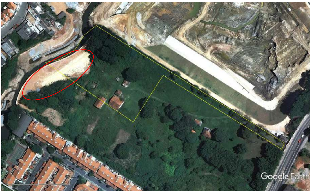
Imagem 4.1.3-3: Imagem Google Earth de 14/12/2008. Notar a presença de um aterro no extremo oeste da área – elipse em vermelho - destinada à URQ, associado à canalização do rio Pirajussara. Ao norte, escavações para a implantação do Piscinão da Sharp.
