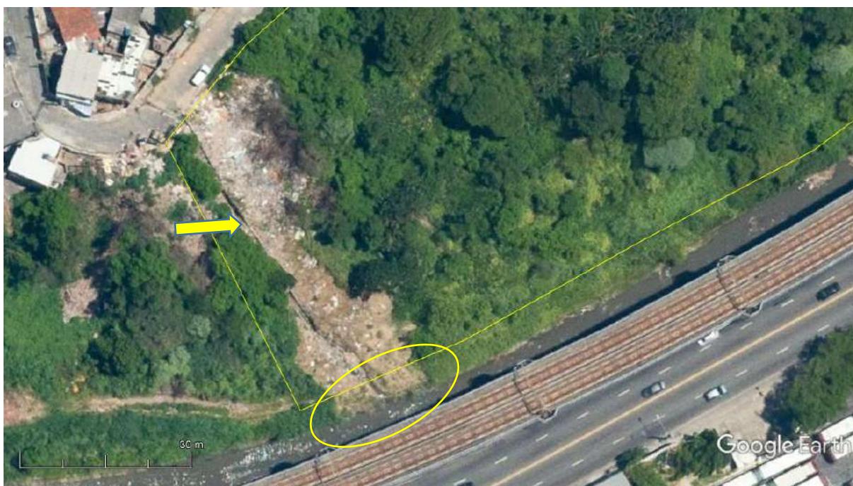
Imagem 4.2.3-4: Imagem Google Earth de 2/11/2014. Depósito de resíduos alcançando o canal do córrego do Morro do S devido a provável escorregamento sobre tais materiais. A seta amarela indica a localização da escada hidráulica.
