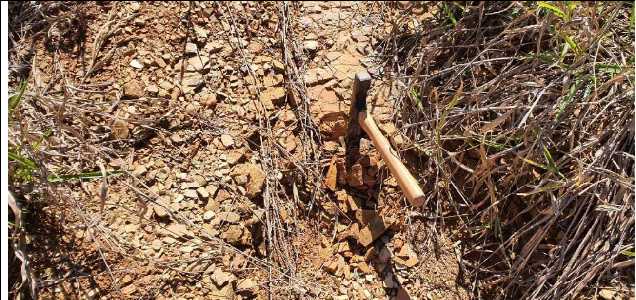
Fotos 7 e 8: Aspectos do solo arenoso, pouco argiloso e dos siltitos alterados que constitui o substrato físico da área.
