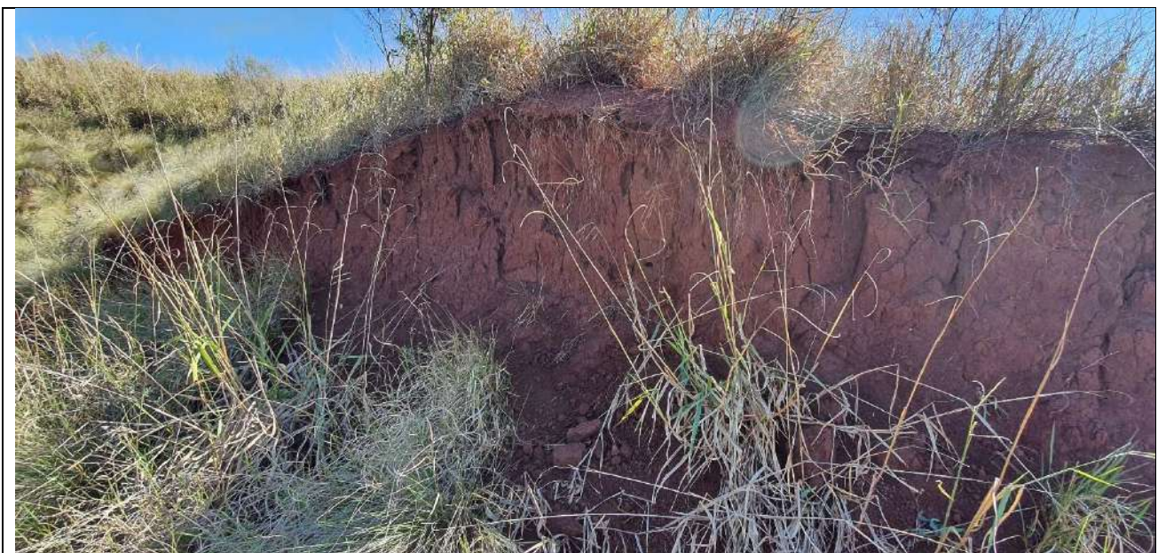
Foto 8: Aspecto dos solos argilo-arenosos vermelhos característicos da alteração a partir do basalto da Formação Serra Geral.
