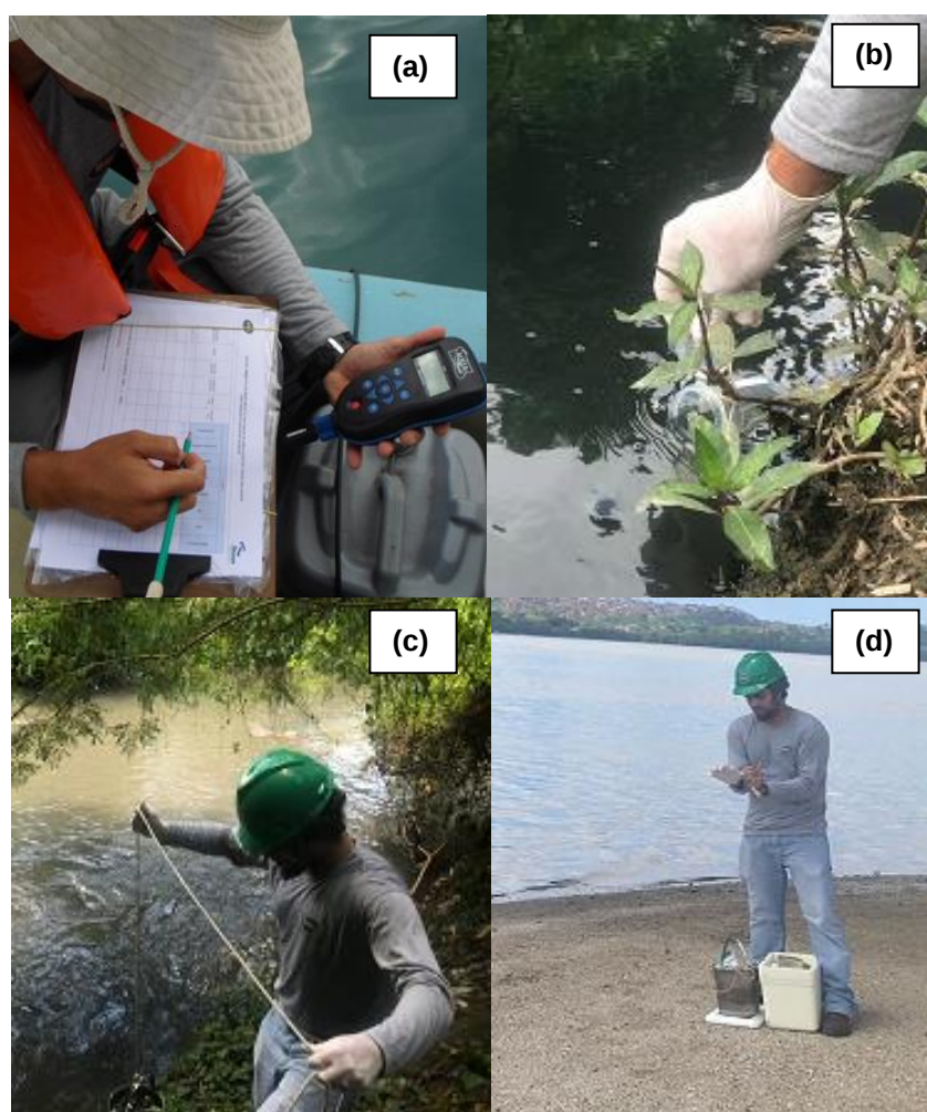
FIGURA 16-5 - Procedimentos de coleta das amostras de água: a) Registro dos parâmetros de campo com a sonda multiparamétrica; b) coleta direta de água para análise em laboratório; c) coleta de água com balde de inox; d) acondicionamento das amostras em caixa isotérmica. Fonte: Elaboração Própria, 2017.
