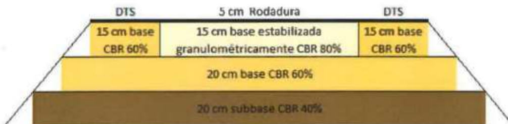
Figura 4-4 Sección tipo-general del pavimento
