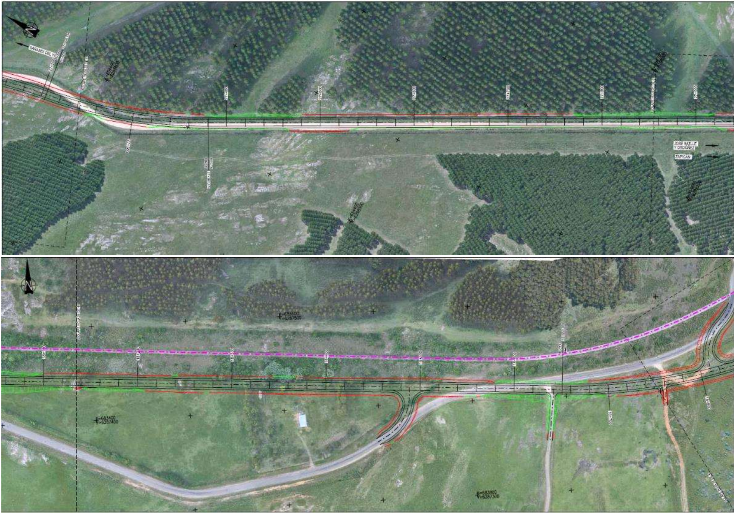
Figura 4-10 Extracto de planos, ejemplo de rectificaciones en tramos N1 (arriba) y N2 (abajo)
