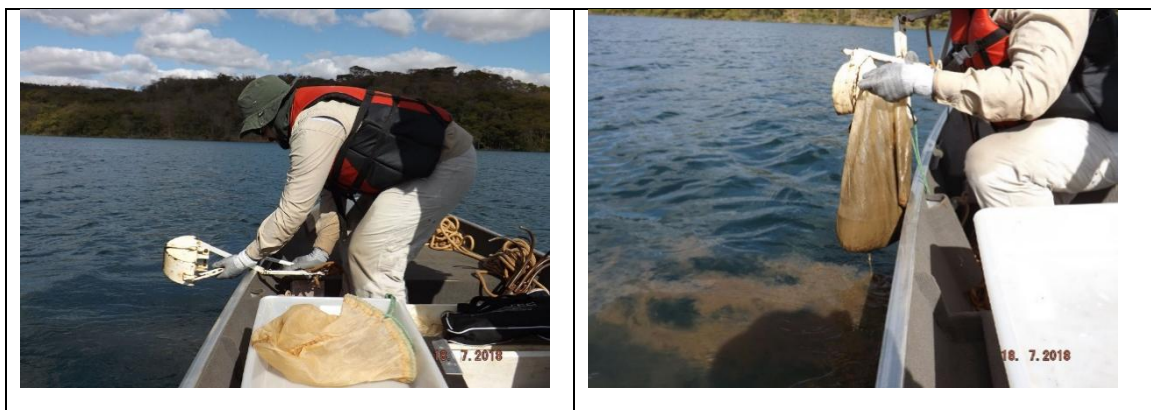
Figura 44 – Metodologia de coleta das comunidades bentônicas do rio Araguari em julho de 2018 (coleta com draga de Van Veen a esquerda e rede de nylon a direita)
