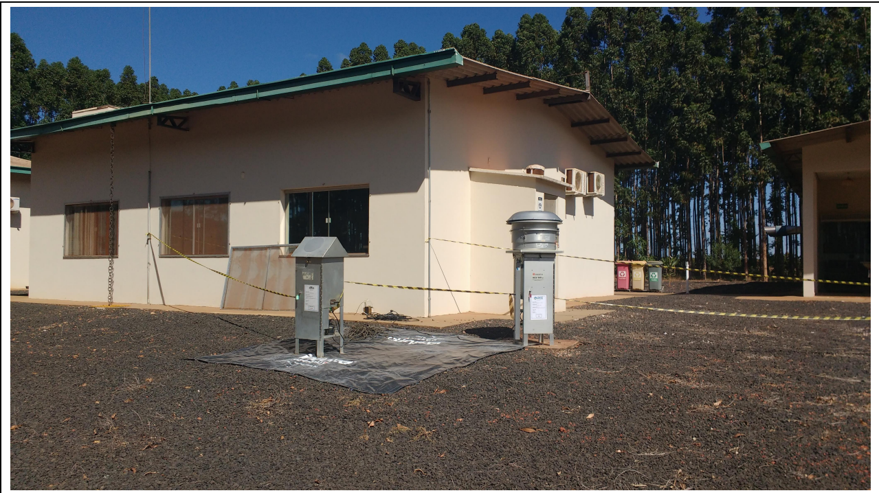
Figura 2 – Visão geral dos equipamentos no ponto de amostragem.
