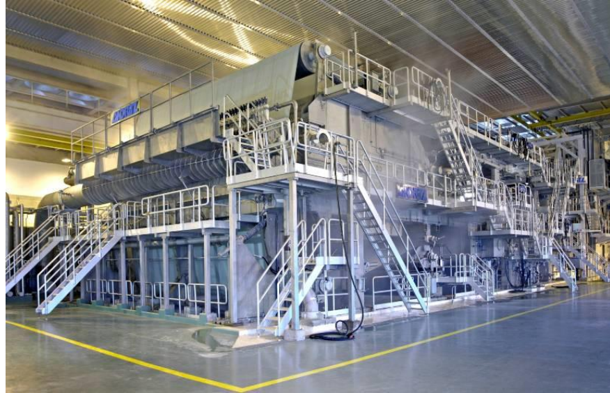
Figura 6 – Máquina de secagem de celulose. Fonte: Pöyry, 2018.
