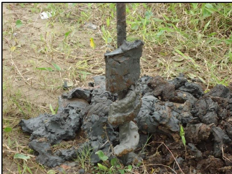
**Foto 12** – Sedimentos inconsolidados na perfuração do poço piezométrico PZ06. Observa-se sedimentos predominantemente arenosos na parte inferior do trado, e sedimentos argilosos na parte superior.
