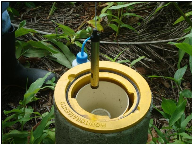
**Foto 09** - Levellogger LTC F100/M30 da Solinst, obtendo medições de profundidade, temperatura e condutividade elétrica.
