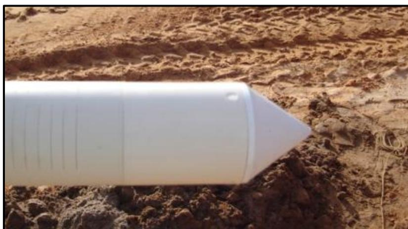
**Foto 05** – Tampão inferior com CAP rosqueável para evitar carreamento de particulados do fundo do poço no momento da coleta.
