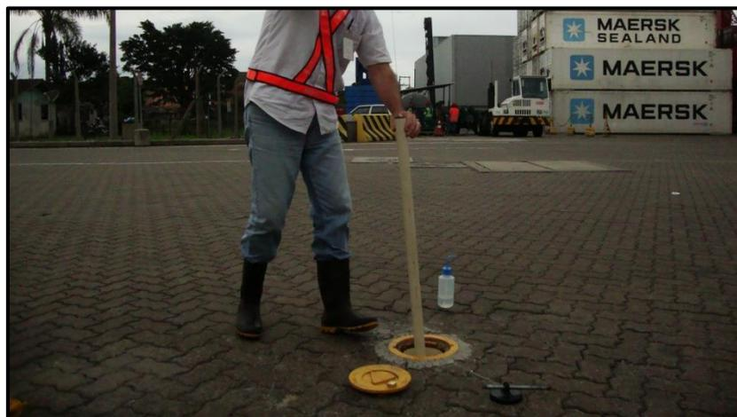
**Foto 10** - Volume sólido de 1,3 litros, responsável pela imediata elevação do nível da água dentro do poço de monitoramento.
