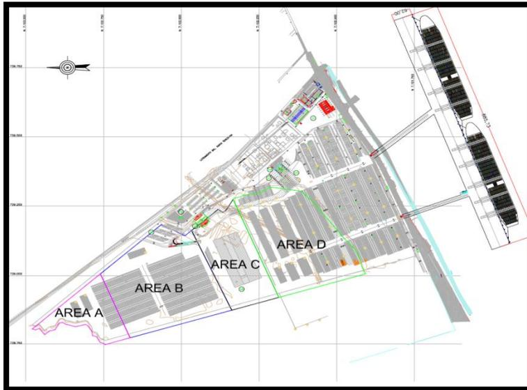
**Figura 11: Delimitação de Áreas para Definição da Cota do Aterro**
