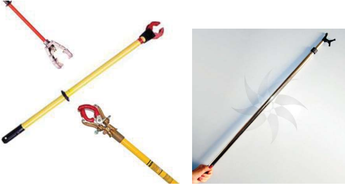
Ilustración 8: Variedad y tipos de pértigas con accesorios para levantar y mantener el cable guía y conductores para evitar así que entren en contacto con árboles, plantaciones y caigan al suelo.
