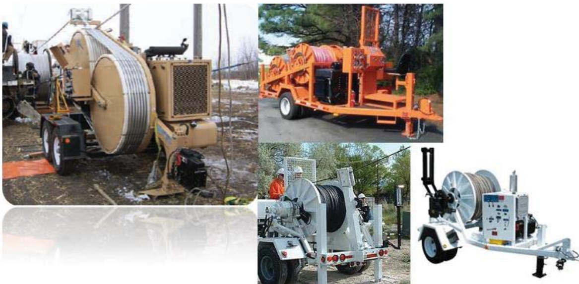
Ilustración 4: VISTA DE EQUIPO DE TRACCION Y FRENO UTILIZADO EN LA ACTIVIDAD DE TENDIDO Y TENSADO.
