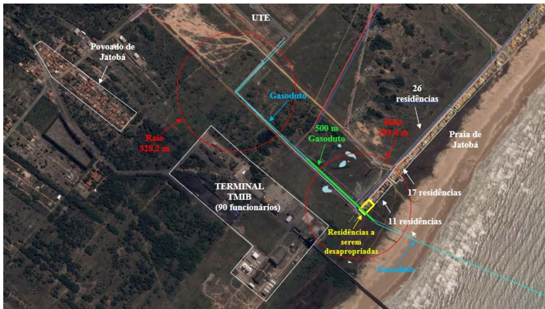
Figura 7.1 – Extensão selecionada gasoduto (500m) e levantamento populacional
