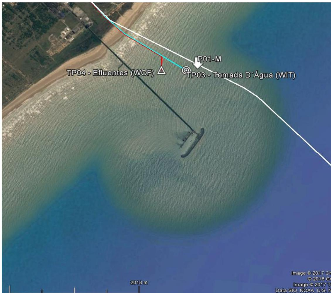
**Figura 2-1:** Vista Geral da parte Off Shore do empreendimento, em vermelho (TP04 – Efluentes [WOF]) é representado o duto de descarte de água resfriada, em azul (TP03 – Tomada de Água [WIT]) duto que irá absorver água, em branco o gasoduto que irá transportar o gás metano, em preto o navio que será ancorado para recebimento do gás vindo de outro navio. Os P01, P02 e P03-M representam os pontos amostrais.
