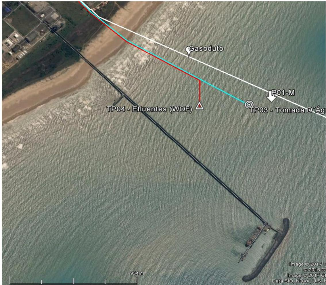
**Figura 2-2:** Vista Geral Off Shore P01-M, em vermelho (TP04 – Efluentes [WOF]) é representado o duto de descarte de água resfriada, em azul (TP03 – Tomada de Água [WIT]) duto que irá absorver água, em branco o gasoduto que irá transportar o gás metano (Coordenadas 727555/ 8801695).
