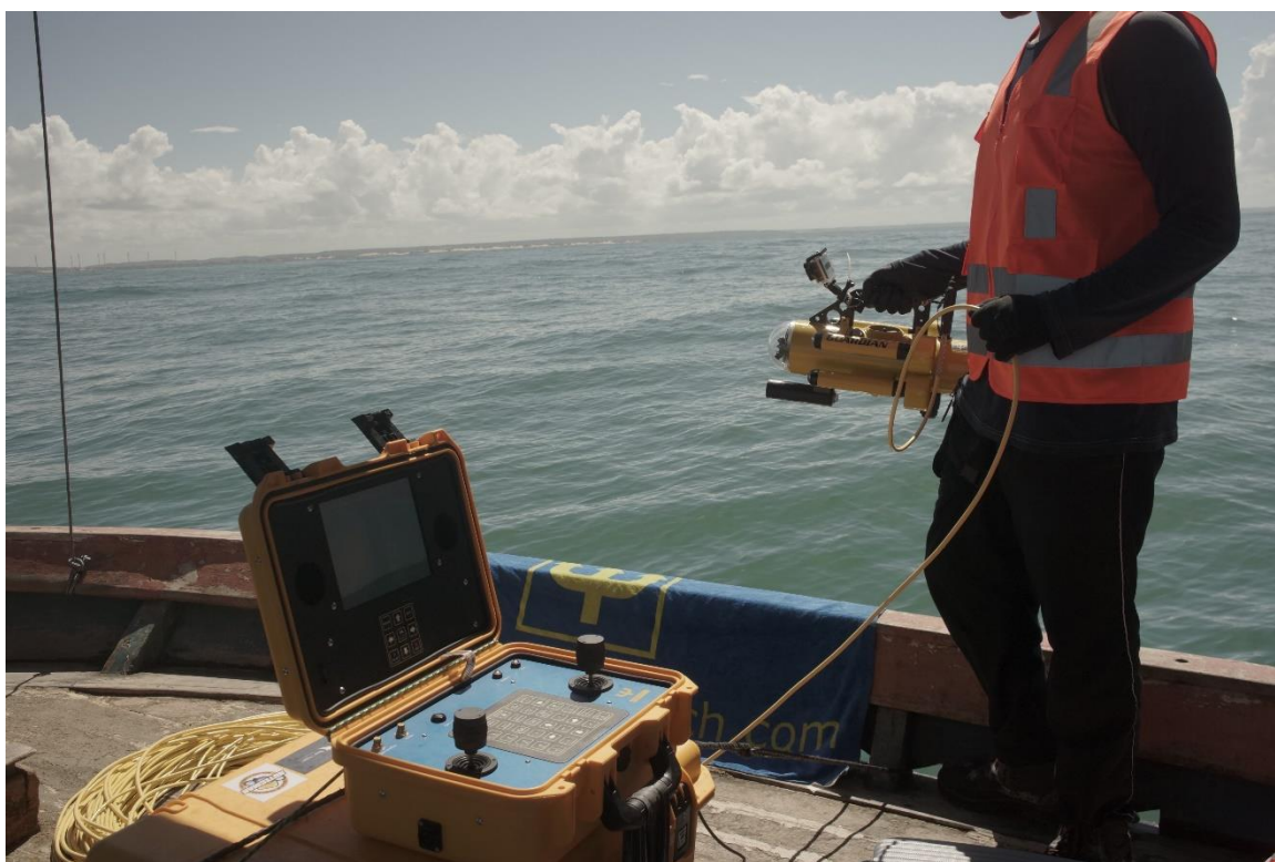
Figura 2: Micro-ROV utilizado nas campanhas.
