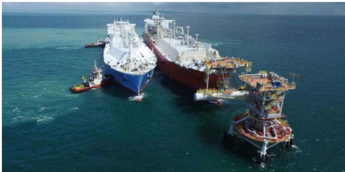
Foto 5-2: Operação de atracação a contrabordo de navio metaneiro a um FSRU ancorado a um yoke em torre
