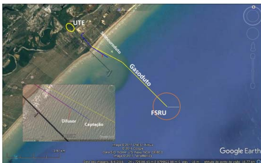
Figura 3-4: Arranjo FSRU, gasoduto e UTE da Alternativa 3
