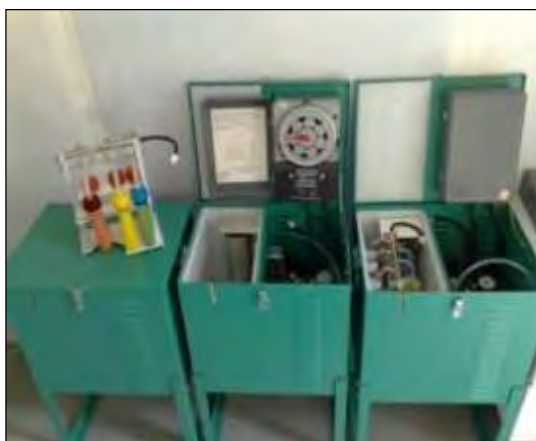
Figura No. 5. Tren de gases y soluciones absorbentes para determinación de \text{NO}_x y \text{SO}_2
