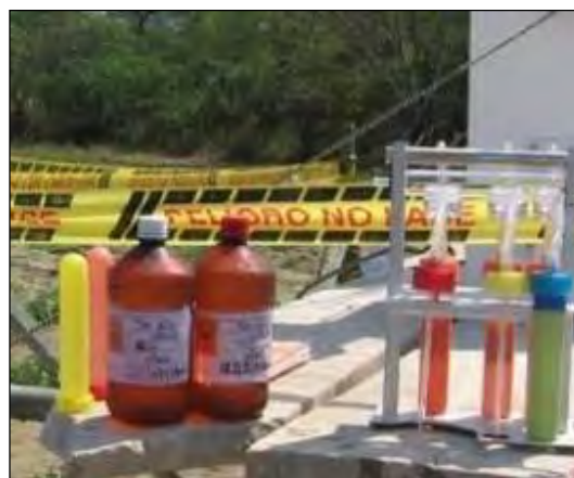
Figura No. 5. Tren de gases y soluciones absorbentes para determinación de \text{NO}_x y \text{SO}_2
