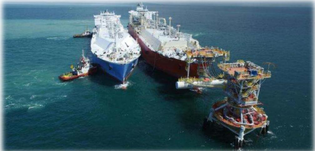
Operação de Transferência de um navio metaneiro supridor para FSRU
