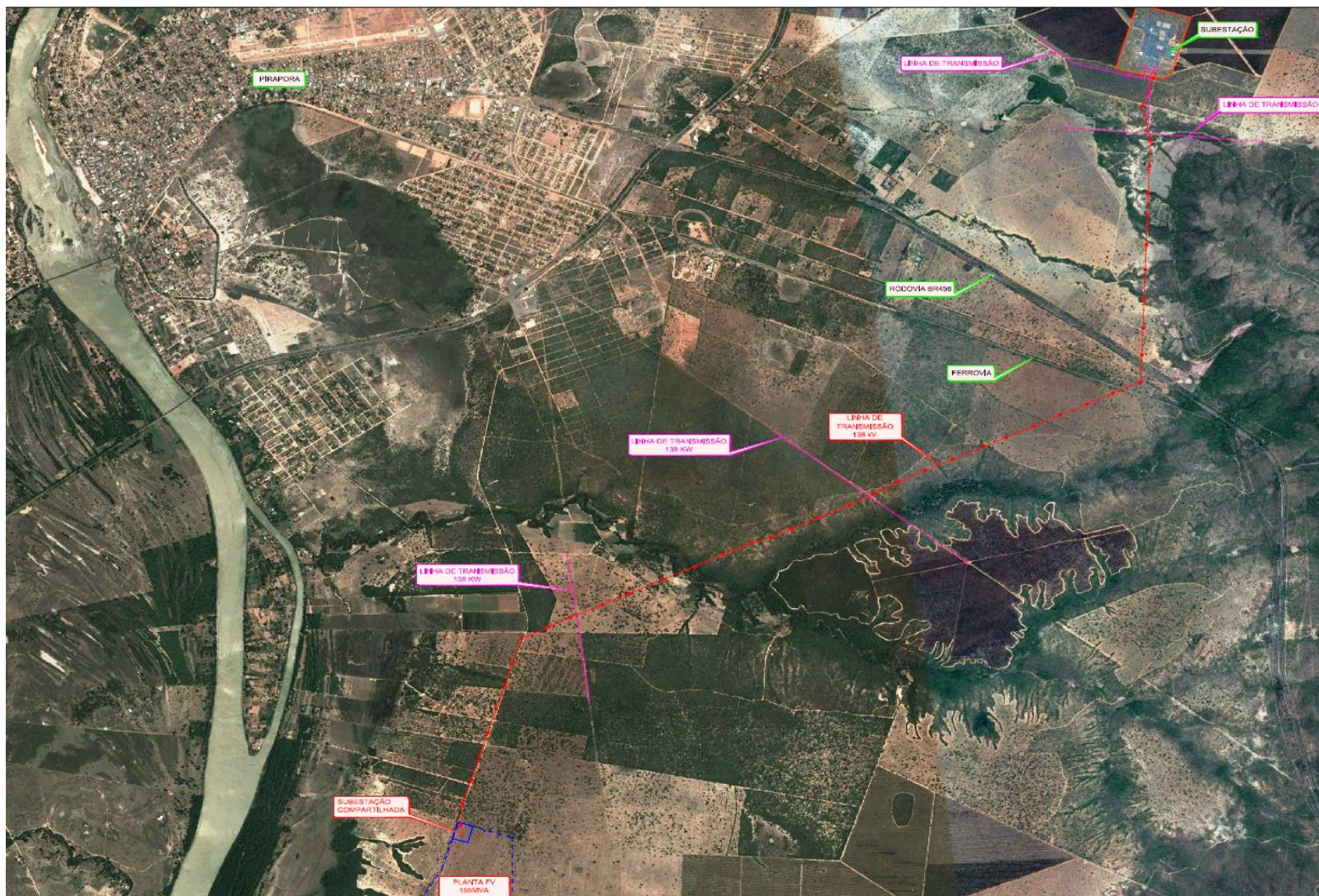
Figura 36. Traçado da Linha de Transmissão.
