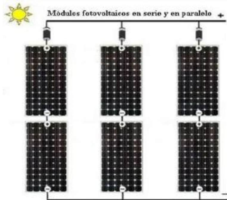
Figura 2.7 Módulos fotovoltaicos conectados en serie y en paralelo (Fuente: www.mpptsolar.com ).
