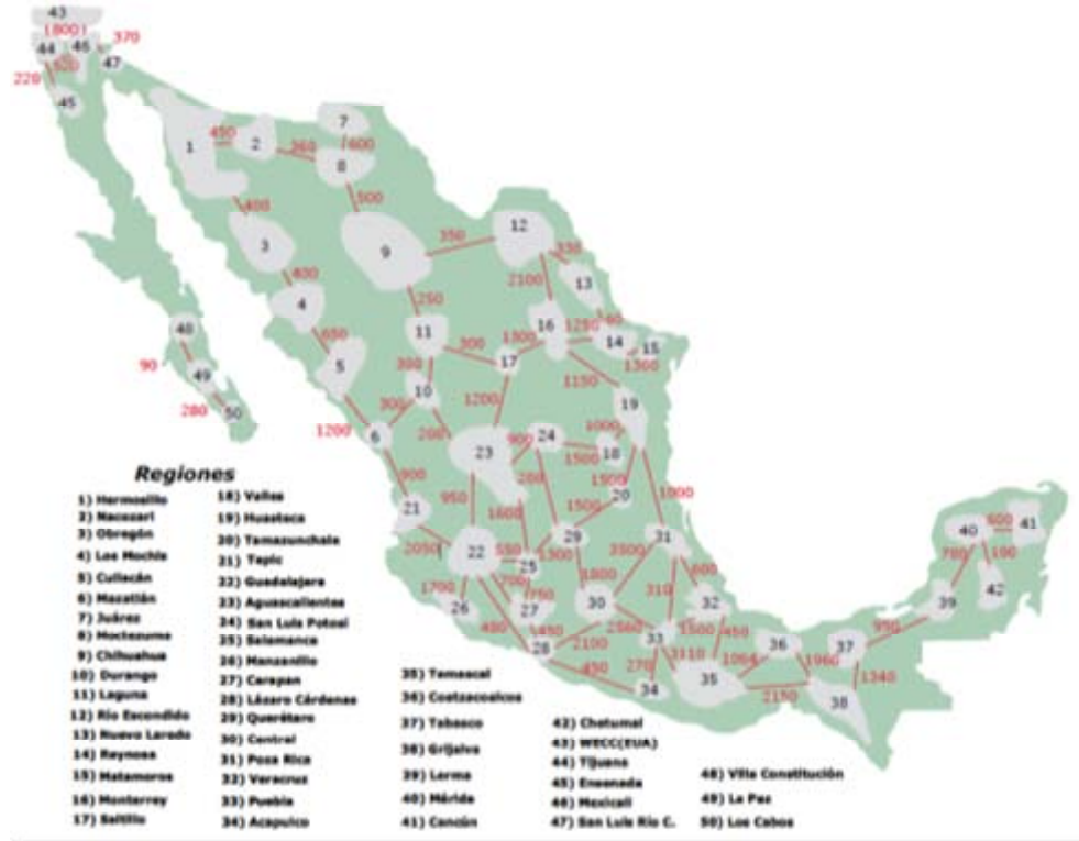
Figura 3.3. Capacidad de Transmisión Entre Regiones (MW) 2010.
