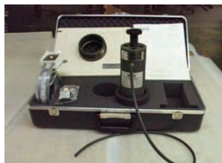
Figura 6.2 Equipamiento que conforma el kit de calibración
