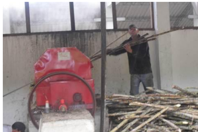
Foto 3-80. Motores eléctricos son utilizados para la molienda de la caña
