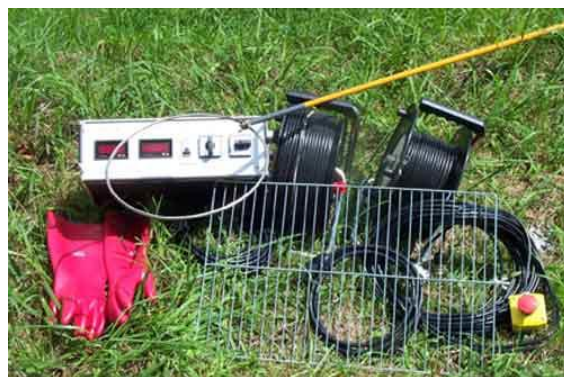
Foto 2.13. Equipo típico para pesca eléctrica. Fuente: Consortio CCA CONSULTORÍA - PLYMA., 2016.
