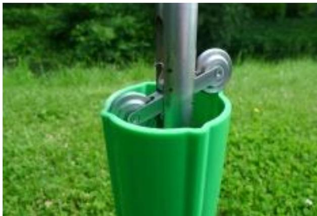
**Figura 11-4 Vista tubería ABS – Inclinómetro**
