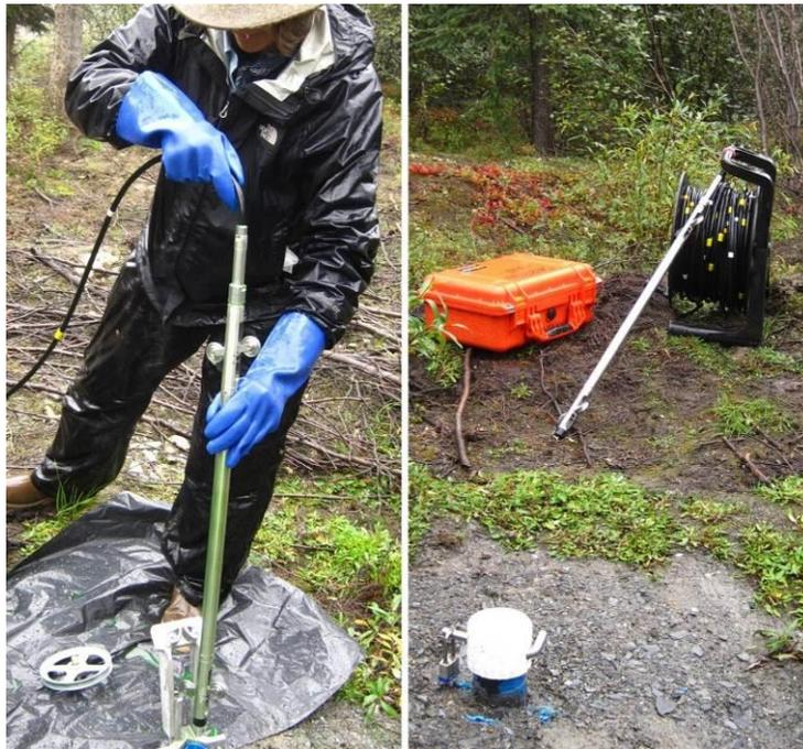
**Figura 11-5 Toma de medición – Inclinómetro**
