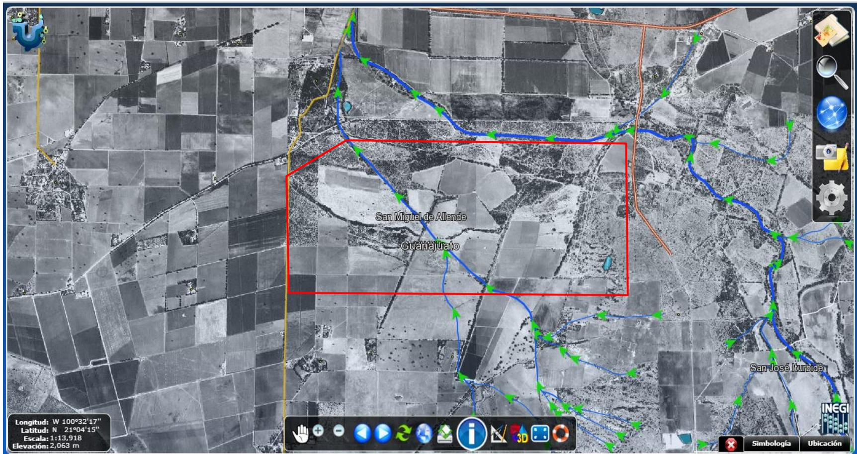
**Figura 28. Determinación de dirección de flujos mediante el Simulador de Flujos de Agua de Cuencas Hidrográficas (SIATL) de INEGI.**
