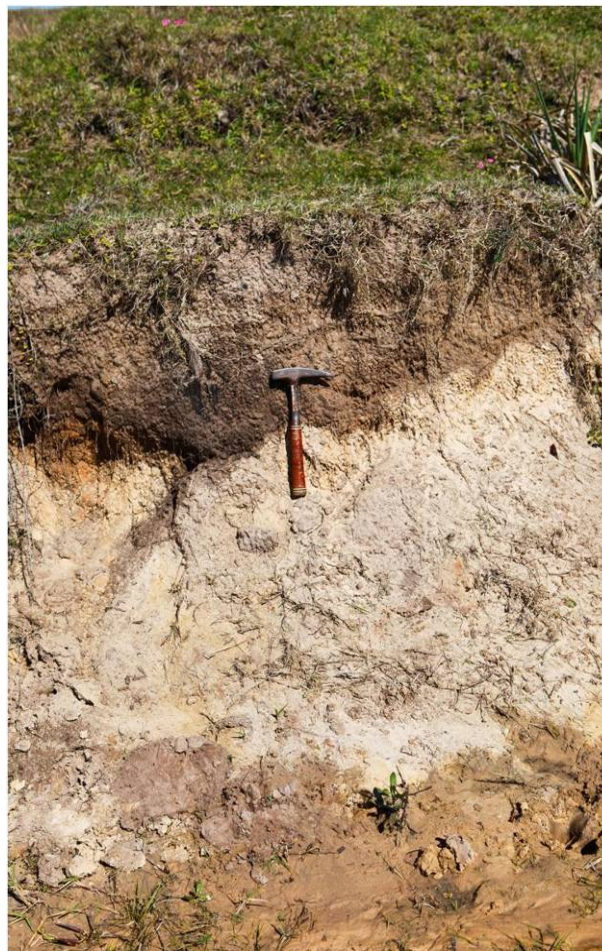
Figura 5.5.5 - Exposição de perfil de solo arenoso com concreções de óxidos de ferro situado no ponto de coordenadas UTM SAD69 x=322704 e y=6327120.
