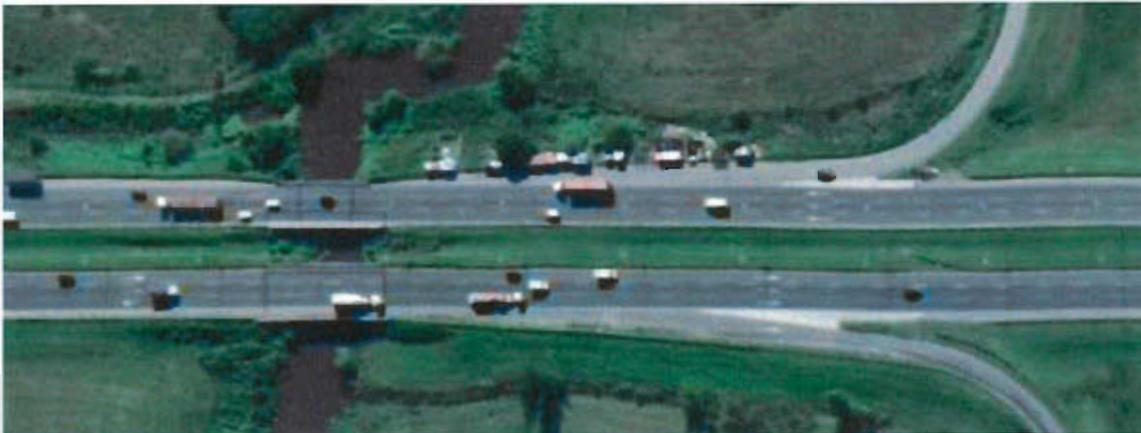
Figura 8 Brazo Arroyo Pesquerías – Situación actual – Puentes sin banquetas y longitud de carriles de aceleración y deceleración a prolongar. Fuente Memoria descriptiva Corredor E. DNV
