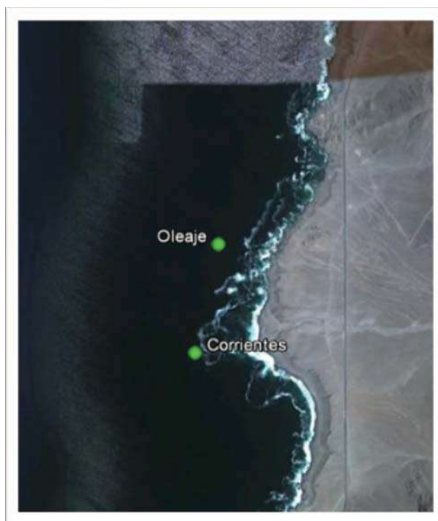
Figura 2.5-9. Posición de los ADCP utilizados para Registrar Corrientes (ADCP Sontek); y Corrientes y Oleaje (ADPC RDI) en el Sector km 14. Campaña de Invierno de 2011 Verano de 2012
