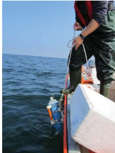
Fotografía 2.5-1. Muestreo de la Columna de Agua de Mar con Botella Oceanográfica, Modelo Niskin 5L
