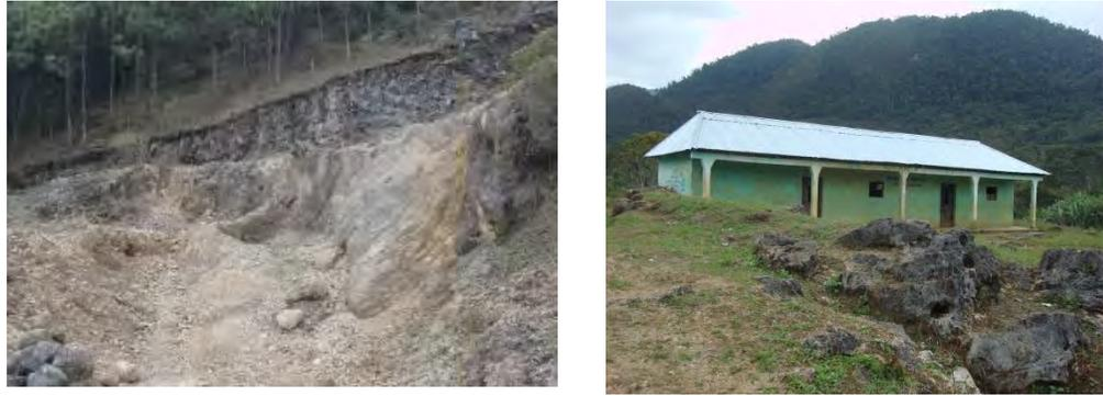
**Figura 8.5.** Afloramiento de roca caliza, fuertemente tectonizada. Banco de material de roca caliza, ubicada cercana a la carretera a San Miguel Ixtatán. Caliza con evidencia de disolución.
