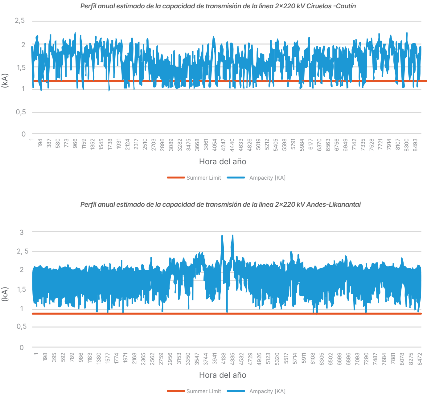
Figura 3.5: Comparación de la capacidad estática de la línea y la capacidad dinámica estimada de la línea.
