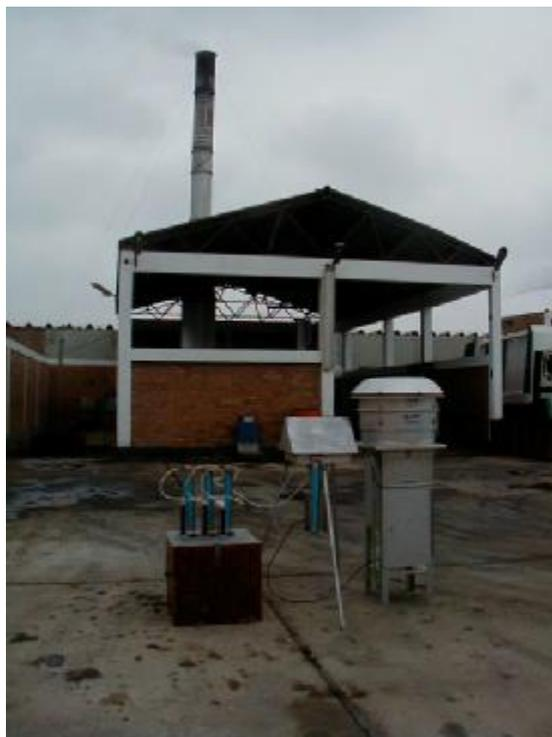
**Foto 5.** Medición de Calidad de Aire en la Zona del Incinerador
